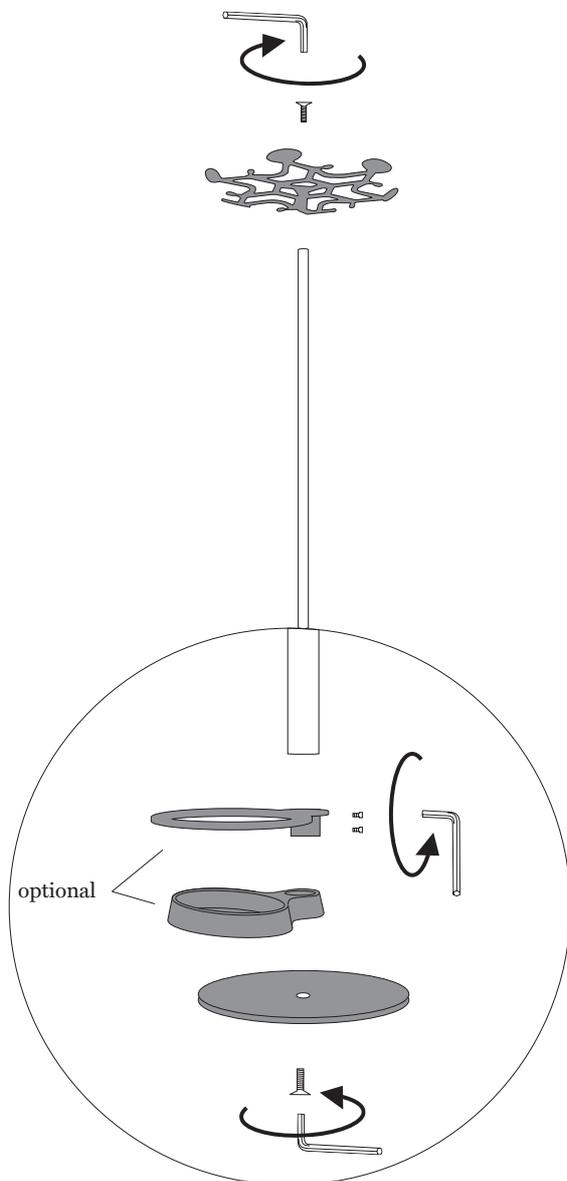
Das lasergeschnittene Top und die Bodenplatte werden mit den beiden Befestigungsschrauben Oben und Unten am Standrohr montiert.
